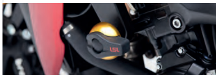
Direkt verschraubt mit den Motorhaltebolzen.
