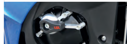
Adapterplatte verschraubt über den Motordeckeln.
