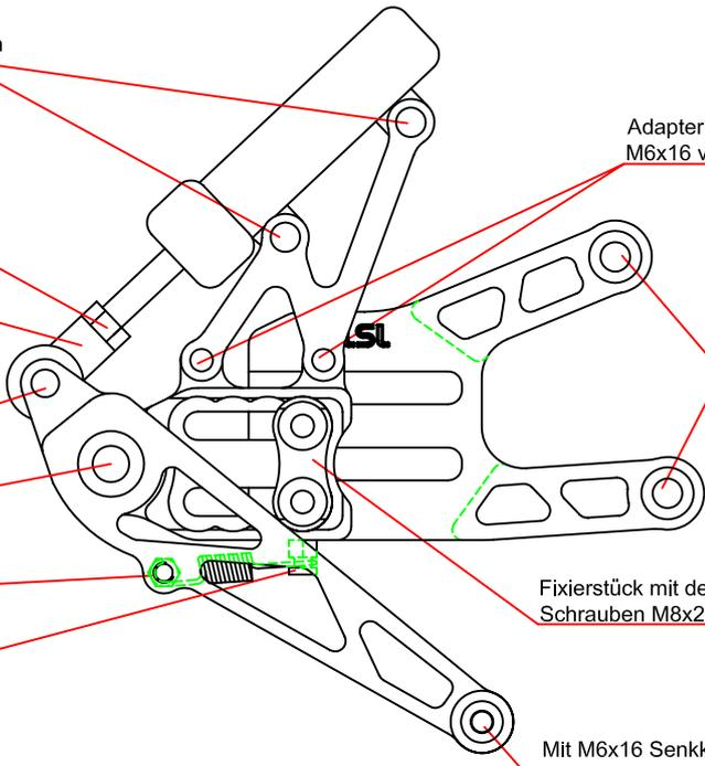
neuen Getriebeschalthebel montieren, vorhandenes Kugelgelenk M6 mit Buchse Ø12x10 und Schraube M6x30 am Getriebeschalthebel verschrauben
